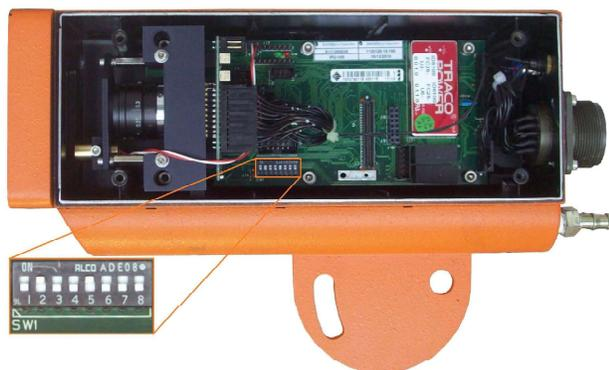
Fig. 4: Posizionamento dei DIP-SWITCH all'interno del fotorilevatore ID6100
