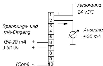
Max. Lastwiderstand der Stromschleife 4...20 mA
