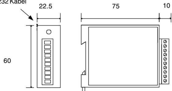
Steckbare Klemmanschlüsse 1,5 mm<sup>2</sup> DIN-Schnapschiene (35mm)
